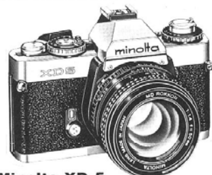
Minolta XD-5 Kompakt elektronisk SLR-kamera med mulighed for både blænder- og lukkerprioriteret automatisk betjening samt fuld manuel betjening. Nyudviklet »Acute-Matte« matskive giver et 50% lysere søgerbillede. Metal spaltelukker med vertikal vandring. Elektromagnetisk udløsesystem. TTL måling via silicium fotocelle. Kontinuerlig drift med Power Wind D indtil 2 bill/sek. og Autoflash 200 x, der følger motoren.
